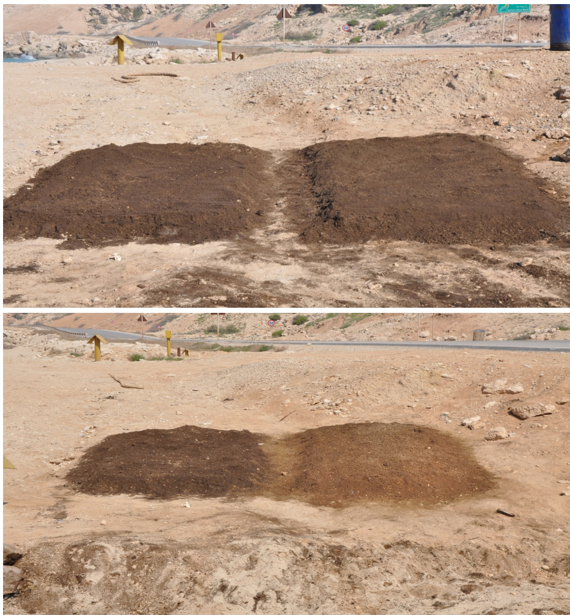
شکل ۳- عکس از نمونه شاهد (چپ) و نمونه مورد آزمایش (راست) در روز اول (بالا) و روز چهاردهم (پایین). تغییر رنگ خاک آلوده در نمونه مورد آزمایش نشان از تجزیه هیدروکربن‌های نفتی موجود در آن می‌باشد
