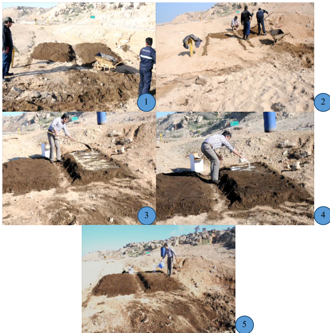
شکل ۱- اجرای عملیات آزمون پایلوت میدانی زیست پالایی خاک‌های آلوده به نفت خام با استفاده از نمونه پودری کنسرسیوم میکروبی تجزیه‌کننده آلاینده‌های هیدروکربنی
