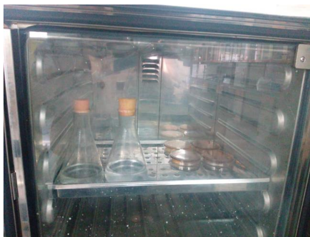
شکل ۱- ارلن های ۲۵۰ میلی لیتری حاوی محیط پایه نمکی محتوی زایلن پس از تلقیح سویه باکتری در انکوباتور Fig. 1- Erlenmeyer flasks contain 100ml MSM and 1ml xylene in the incubator after microbial inoculation
