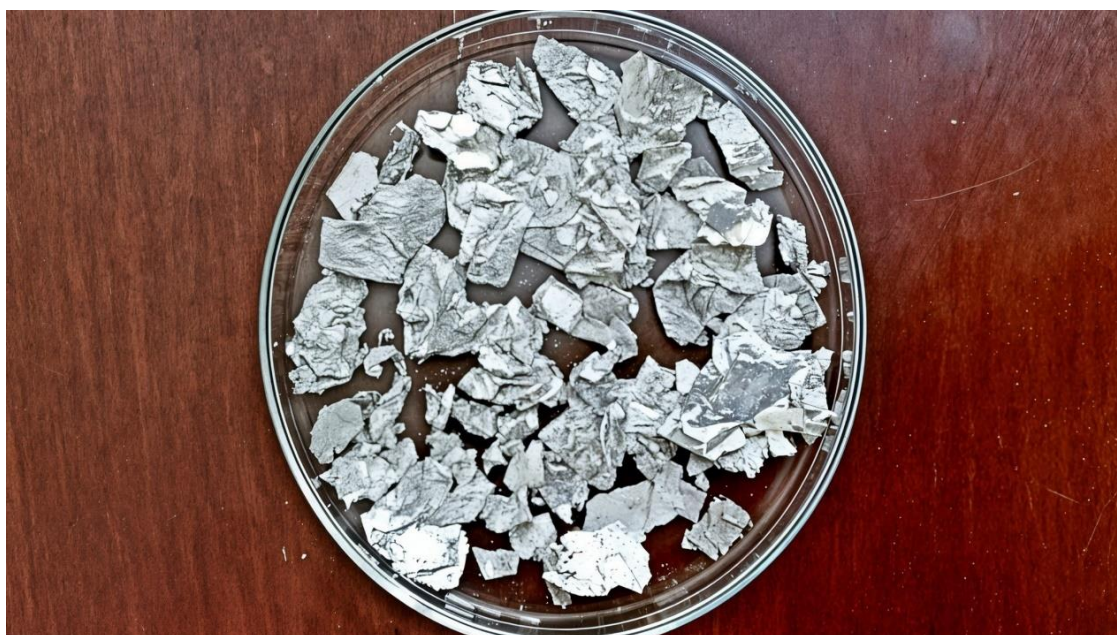
شکل ۳- آلومینیوم خالص باقی مانده از کامپوزیت Al-PE. Fig. 3- Pure aluminum remaining from the Al-PE composite.
