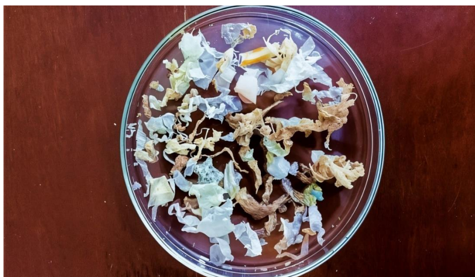
شکل ۲- پلی‌اتیلن خالص باقی‌مانده از کامپوزیت Al-PE. Fig. 2- Pure polyethylene remaining from the Al-PE composite.
