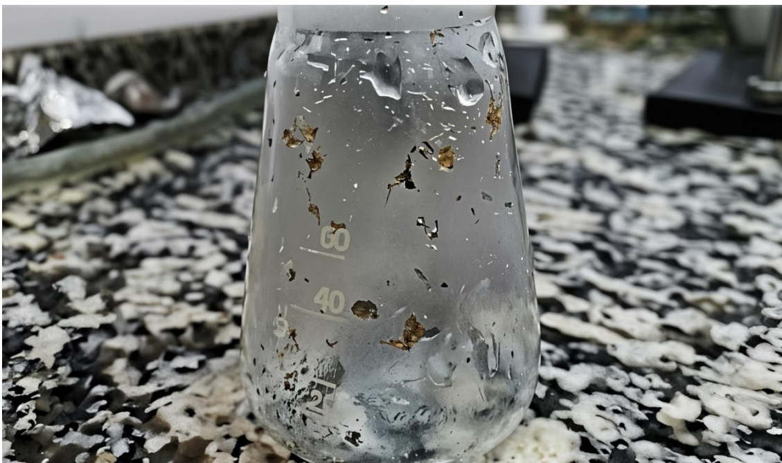
شکل ۵- مشاهدات مربوط به رفتار انحلالی پلی‌اتیلن. در برخی آزمایش‌ها که درصد حجمی آب بیشتر بود، لزجت پلی‌اتیلن به حدی می‌رسید که دیواره‌های ارلن چرب می‌شد. در این حالت، ویسکوزیته پلی‌اتیلن سبب می‌گشت تا برخی قطعات پس از پردازش به دیواره بچسبند.
