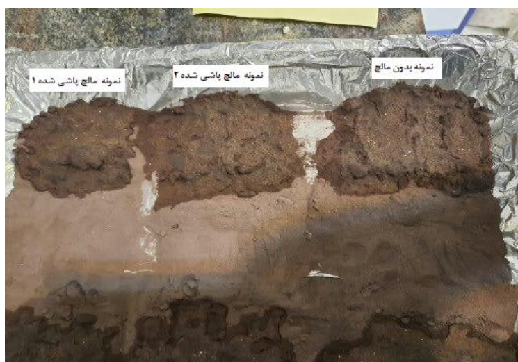
شکل ۲- نمونه خاک باطله مالچ پاشی شده و نشده معدن آهن چادرملو در آزمایش اول.
