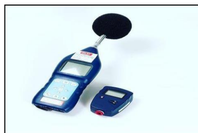
شکل ۲- نمایی از دستگاه تراز سنج صوت Fig. 2 - A view of the sound leveling device
