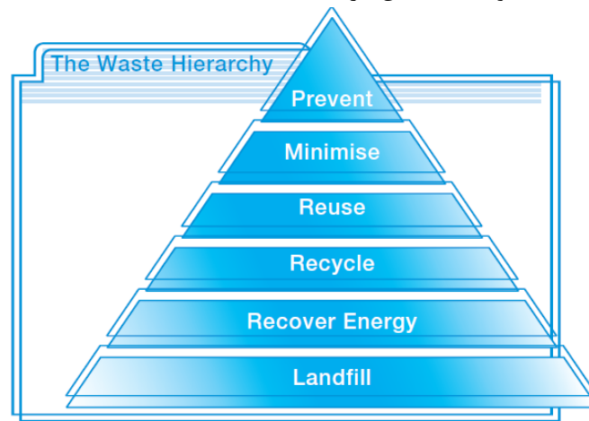
شکل ۱ - سلسله مراتب مدیریت زباله از جنبه ی تأثیرات زیست‌محیطی (Roch, 2005). Fig. 1- The hierarchy of waste management in terms of environmental impact (Roch, 2005).
