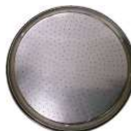
شکل ۶- نمونه صفحه فلزی ایمپکتور بعد از فرایند نمونه برداری Fig. 6- Sample Impactor metal plate after sampling process
