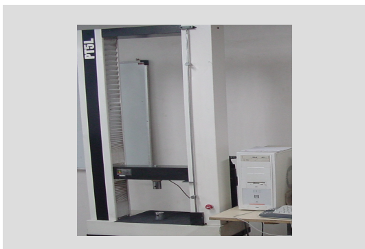
شکل ۳- دستگاه تستینگ استفاده شده جهت اندازه گیری مقاومت خمشی و چسبندگی داخلی نمونه‌های آزمایشی
