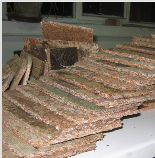
شکل ۵- نمونه‌های اولیه آزمایشی با ضخامت ۱۰ تا ۱۶ میلی‌متر ساخته شده از خرده چوبهای درشت
