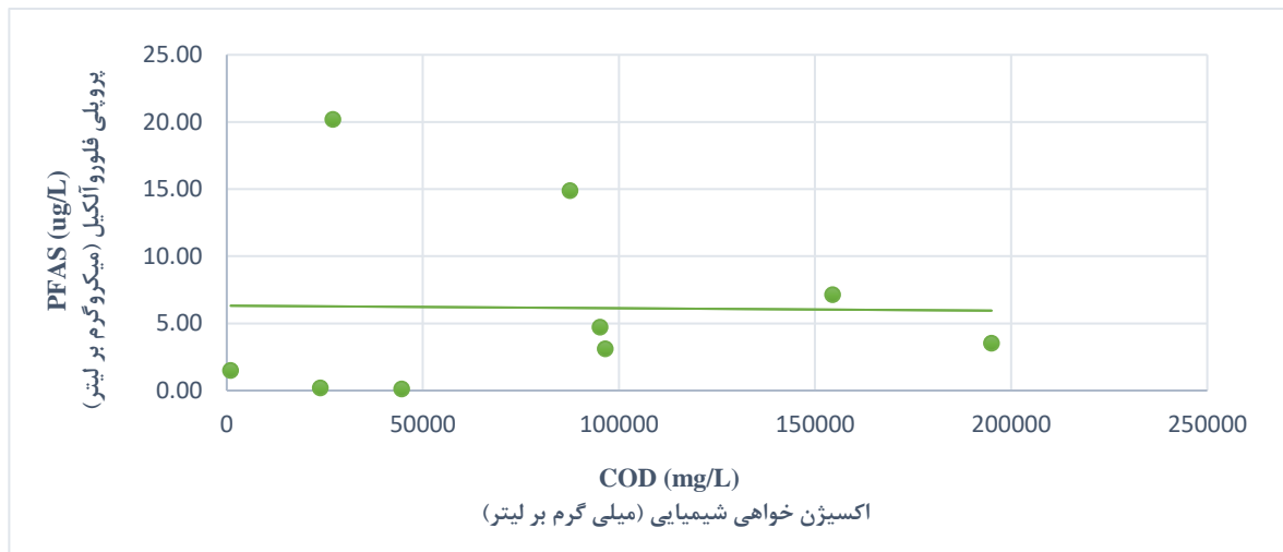
شکل ۶- رابطه بین غلظت مواد پرو پلی فلئوروالکیل و اکسیژن خواهی شیمیایی در شیرابه
