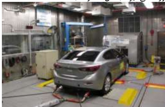
شکل ۱- نحوه اندازه‌گیری در دستگاه شاسی دینامومتر Fig. 1- Chassis dynamometer testing
