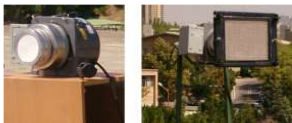
شکل ۲- نمونه بردار حجم بالا در زمان برداشت نمونه با دو فیلتر متفاوت Fig. 2. High volume sampler at sample time with two different filters
