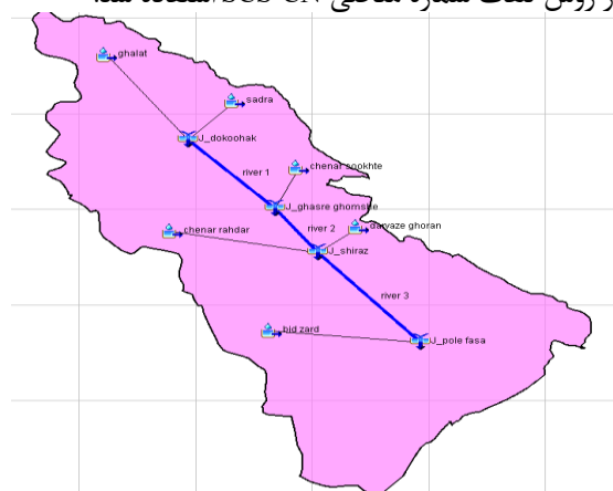
شکل ۲- طرح شماتیک محدوده مطالعاتی شیراز در نرم‌افزار HEC-HM Fig. 2- Schematic design of the study area in Shiraz in HEC-HMS software
